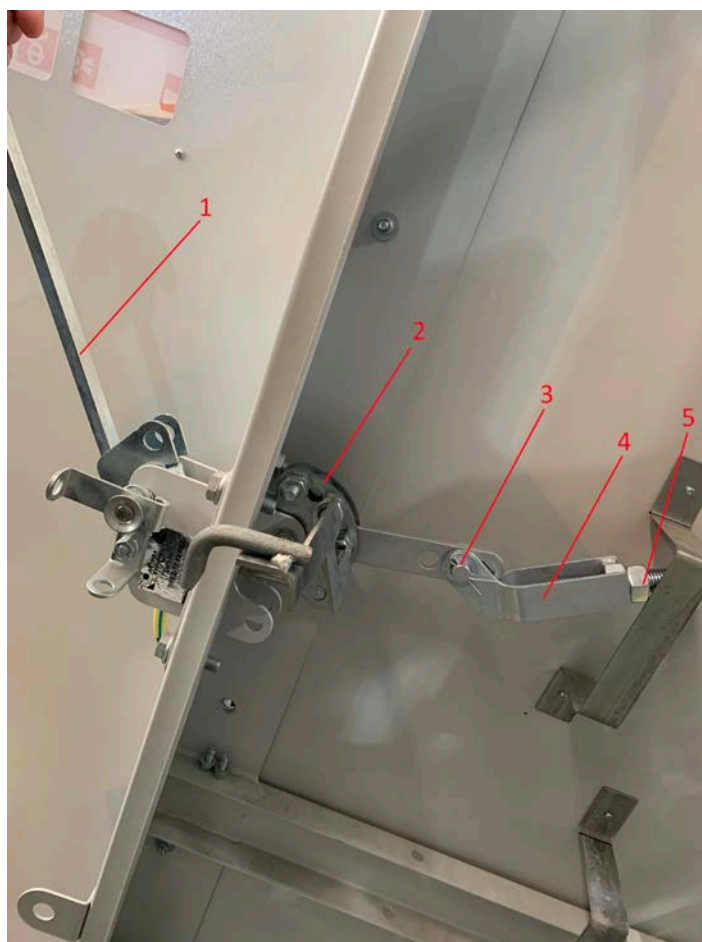
Рисунок 2 – Привод выключателя нагрузки
